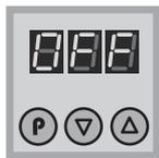
El corte 1 no funciona. El equipo funciona como indicador solamente.
