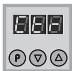
El relé se acciona utilizando el PID *autotuning*.
