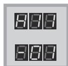
**Histéresis del corte 1:** va de  $-50^{\circ}\text{C}$  a  $50^{\circ}\text{C}$
